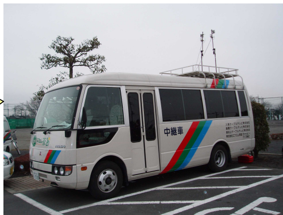
2 面ダイバアンテナによる中継車での受信
